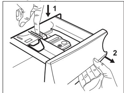
2. Retire la parte superior del compartimento de aditivo para facilitar la limpieza. Asegúrese de eliminar todos los restos de detergente de la parte superior e inferior del hueco. Utilice un cepillo pequeño para limpiar el hueco.
