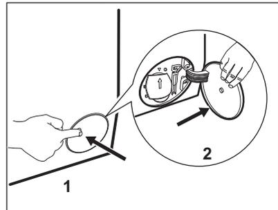
2. Coloque un recipiente debajo de la bomba de desagüe para recoger el agua que salga.
