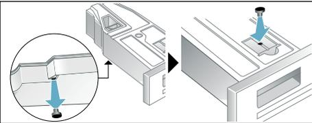
8. Soltar el filtro del enganche y colocarlo en la ranura del recipiente para agua condensada.
