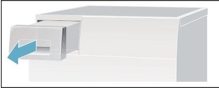
2. Vaciar el agua condensada.
