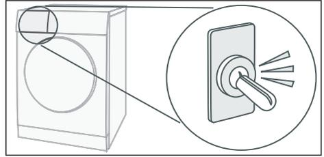
El agua condensada se bombea mediante una bomba al recipiente de agua condensada. Durante dicho proceso se generan ruidos de bombeo.
