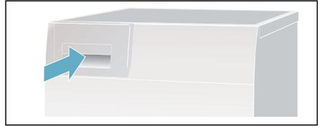
**Nota:** El filtro ubicado en el recipiente de agua de condensación filtra el agua de condensación que se utiliza para la limpieza automática de la secadora. El filtro se limpia al vaciar el agua de condensación. No obstante, es necesario comprobar periódicamente el filtro y eliminar los posibles residuos que se hayan podido acumular. Ver → *Página 35.*
