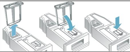
9. Insertar el recipiente para agua condensada hasta que quede encajado.
