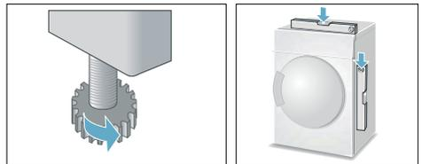
Una posición inadecuada puede causar ruidos molestos, vibraciones y un giro defectuoso del tambor.
