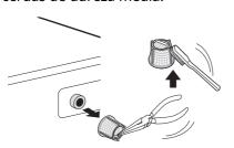
Limpieza de la bomba de desagüe y realización de una evacuación de aqua por emergencia
