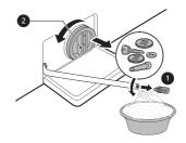
4 Después de limpiar el filtro de la bomba de desagüe, reinserte con cuidado el filtro y enrosque la tapa girándola hacia la derecha con cuidado para evitar apretarla en
