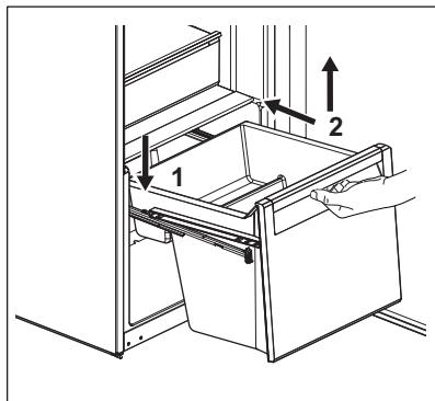
3. Mantenga la parte delantera del cajón (2) levantada mientras empuja el cajón hacia dentro.
