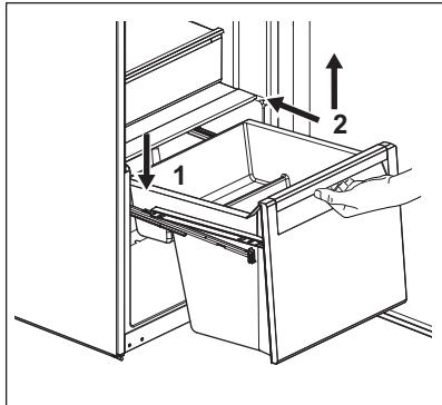
3. Mantenha a parte dianteira da gaveta (2) levantada enquanto empurra a gaveta para dentro.
