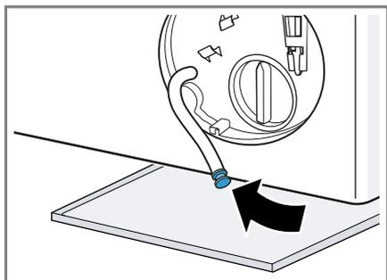
10. Sujetar el tubo de drenaje a la sujeción.
