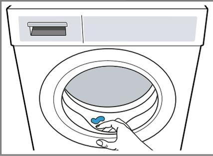
4. Dejar el compartimento para detergente y la puerta abiertos para que pueda secarse el agua residual.
