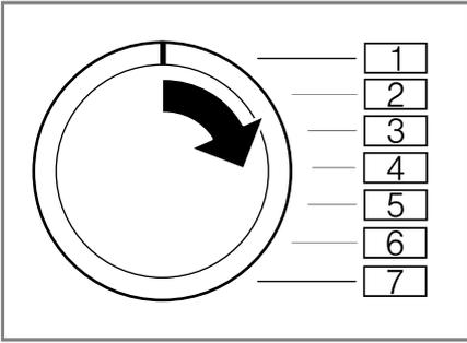
2. Pulsar **Inicio/Pausa + Carga** y colocar simultáneamente el selector de programas en la posición 2.
