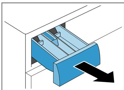
2. Presionar hacia abajo la pieza insertada y extraer el compartimento para detergente.
