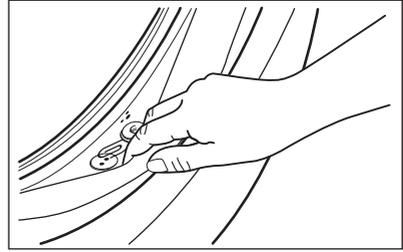
Examine periódicamente la junta y extraiga todos los objetos de la pieza interior.
