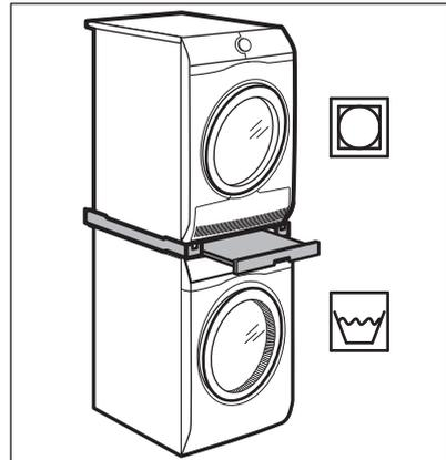
La secadora de tambor puede apilarse sobre la lavadora **solo si se utiliza el kit de apilamiento fabricado y aprobado por AEG.**
