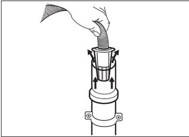
5. Sin la guía de plástico de la manguera, a un desagüe de fregadero - Coloque la manguera de desagüe en el sumidero y sujétela con una pinza. Consulte la ilustración.
