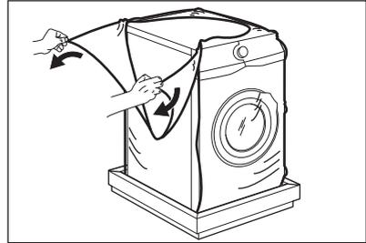
4. Abra la puerta y retire la pieza de poliestireno de la junta de la puerta y todos los elementos del tambor.
