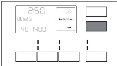
5. Para establecer la dosis básica, toque los botones del depósito hasta que aparezca la dosis predeterminada del producto de lavado y dos flechas en la parte inferior de la pantalla. Toque el botón Temp. °C repetidamente para ajustar la dosis hacia arriba y Centrif. para ajustarla hacia abajo. El paso mínimo es de 1 ml.
