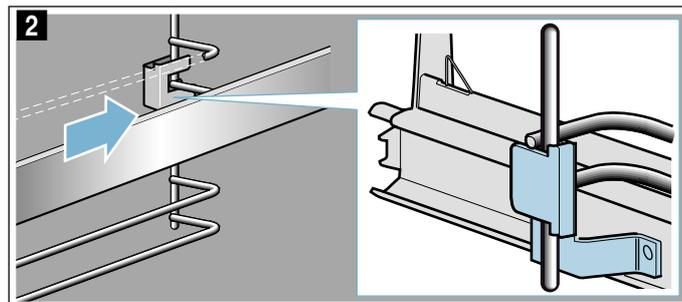
3. Presionar «PUSH» e inclinar el riel hacia dentro, de forma que el soporte quede situado entre ambas barras (figura 3).
