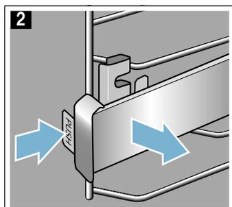
3. Tirar del riel hacia delante hasta que la sujeción se desenganche (figura 3).
