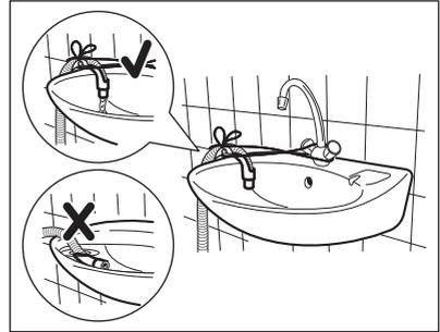
**i** Asegúrese de que la guía de plástico no se mueve cuando el aparato descarga y que el extremo del tubo de desagüe no esté sumergido en el agua. Puede que vuelva agua sucia al aparato.
