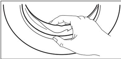
Examine periódicamente la junta y extraiga todos los objetos de la pieza interior.
