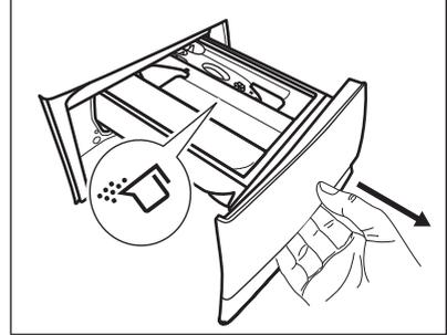
2. Presione la palanca hacia abajo para extraer el dosificador.
