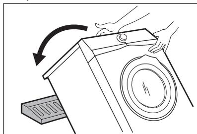
5. Retire la protección de poliestireno de la base. Vuelva a colocar el aparato en posición vertical.
