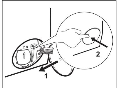
Cuando se desagua con el procedimiento de drenaje de emergencia, se debe activar de nuevo el sistema de desagüe:
