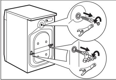
8. Coloque los tapones de plástico que encontrará en la bolsa del manual del usuario en los orificios.
