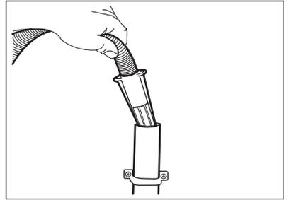
**5. Sin la guía de plástico de la manguera, a un desagüe de fregadero** - Coloque la manguera de descarga en el sumidero y sujétela con una pinza. Consulte la ilustración.
