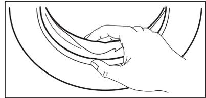
Examine periódicamente la junta y extraiga todos los objetos de la pieza interior.
