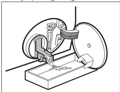
5. Cuando el recipiente esté lleno de agua, vuelva a colocar el conducto y vacíe el contenedor.
