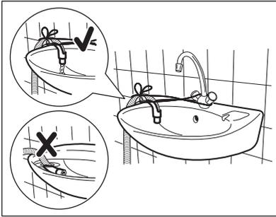
**i** Asegúrese de que el extremo del tubo de desagüe no esté sumergido en el agua. Puede que vuelva agua sucia al aparato.
