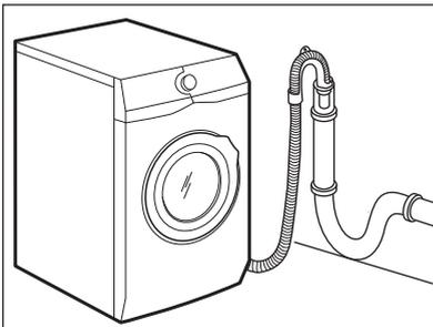
**i** El extremo del tubo de descarga siempre debe estar ventilado; es decir, el diámetro interno del tubo de desagüe (mín. 38 mm - mín. 1,5") debe ser mayor que el diámetro externo del tubo.
