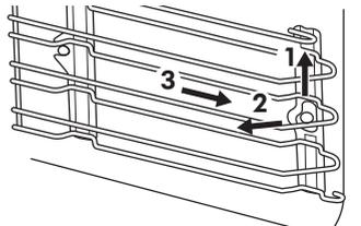
2. Tire del extremo delantero del carril de apoyo para separarlo de la pared.
