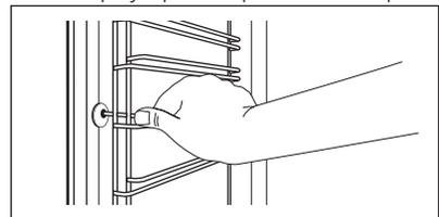
2. Tire del extremo trasero del carril de apoyo para despegarlo de la pared y extráigalo.
