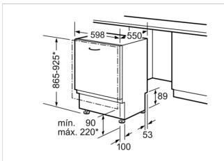
\* Mediante patas atornilladas de altura regulable Altura del zócalo para altura de aparato 865 90-160 mm Altura del zócalo para altura de aparato 925 150-220 mm
